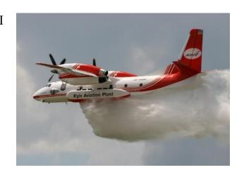
полосы составляет 120-160, ширина — 10-35 метров. В хвостовой части самолета Ан-32П находится метеопушка. Расстрел облаков специальными патронами, в состав которых входит соединение серебра, вызывает выпадение осадков над зоной возгорания.
